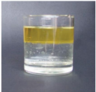
静置后的油水混合物
