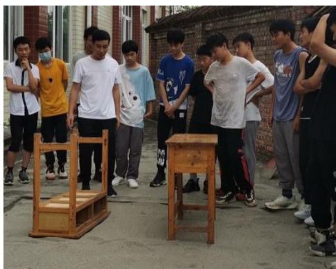
（图为：通过沙子的凹陷程度反映压力作用效果与受力面积的关系）
